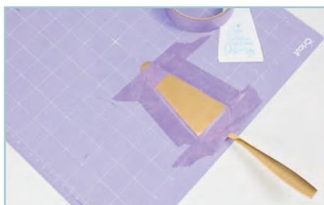
3 Setze das QuickSwap-Gehäuse mit der Gravurspitze in dein Cricut-Gerät ein. Wähle als Materialeinstellung „Metall“ („Stainless Steel“) aus. Setze die Matte ein und starte den Vorgang.
