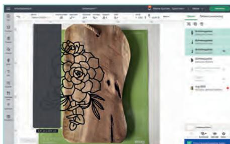
2 Spiegle dein Motiv (obere Menüleiste) und klicke auf „Herstellen“. Setze die Feinschnittklinge ein und wähle eine passende Schnitteinstellung für die Flockfolie (z. B. „100“). Klebe die Folie mit der transparenten Trägerfolie nach unten auf die Matte und schneide die Datei.
